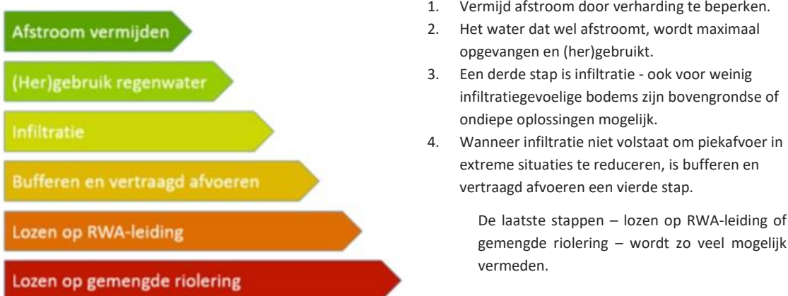
Figuur 15: Ladder van Lansink - toepassen van maatregelen over verwerking hemelwater. Bron: Leidraad ontwerpen van bronmaatregelen – Integraal waterbeleid
