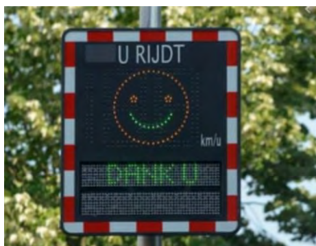
Figuur 113: snelheidsinformatiebord met de smiley-functie
