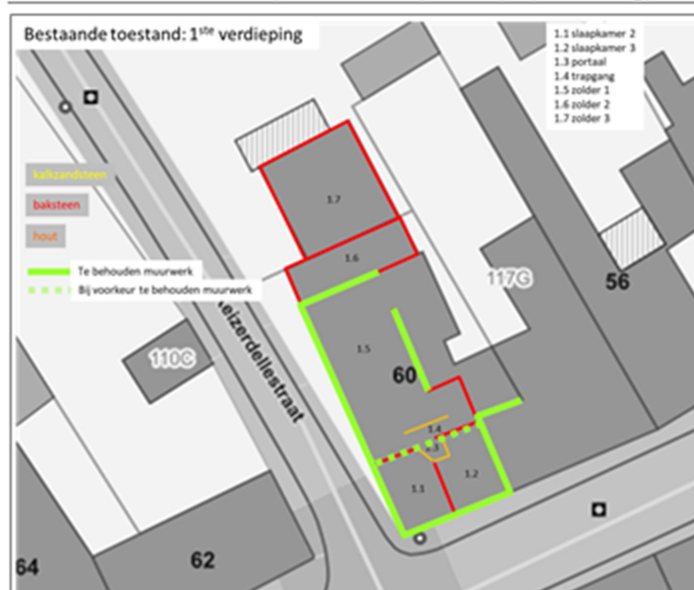
Figuur 65. Bestaande toestand van de 1 ste verdieping van het pand Peperstraat 60 in Erps-Kwerps met aanduiding in het groen van het te behouden en bij voorkeur te behouden muurwerk.
