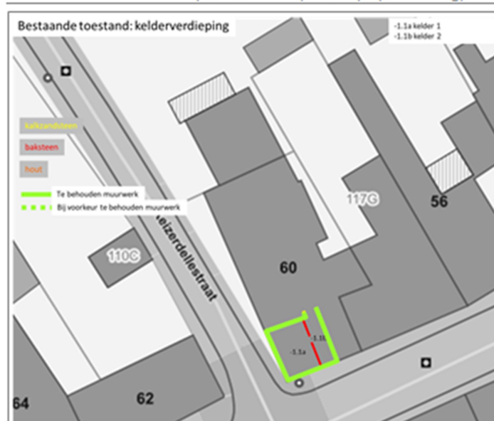
Figuur 65. Bestaande toestand van de kelder van het pand Peperstraat 60 in Erps-Kwerps met aanduiding in het groen van het te behouden en bij voorkeur te behouden muurwerk.
