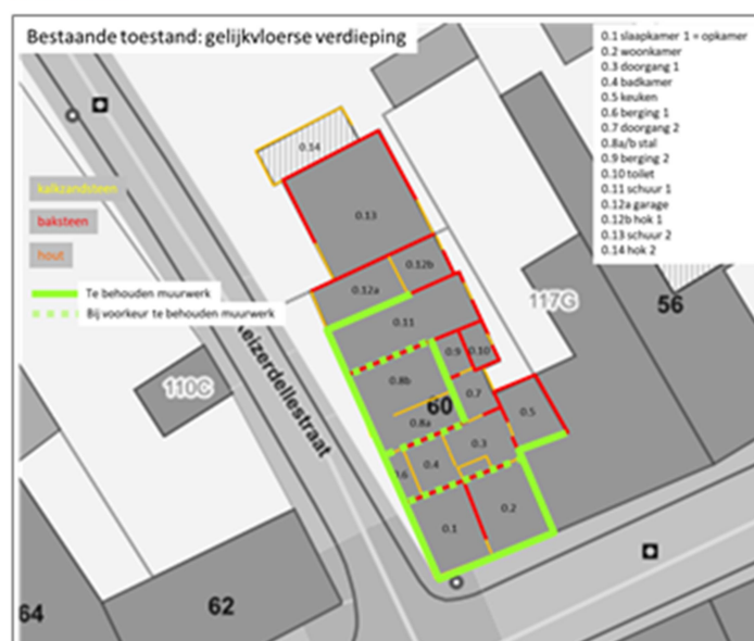
Figuur 65. Bestaande toestand van het gelijkvloers van het pand Peperstraat 60 in Erps-Kwerps met aanduiding in het groen van het te behouden en bij voorkeur te behouden muurwerk.
